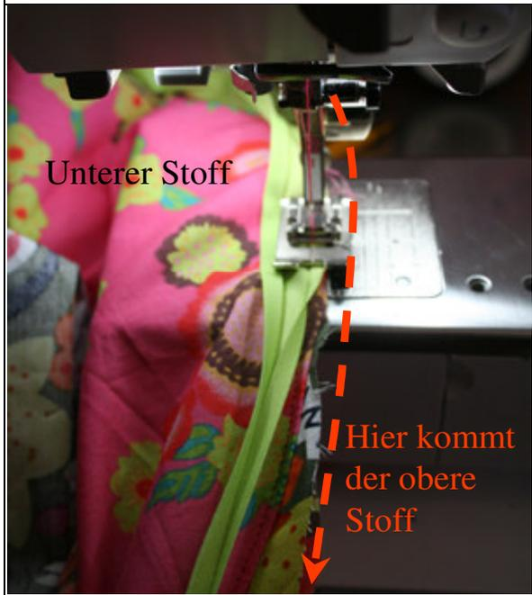
Den Saum entlang nähen, und man trifft automatisch auf den Übergang zum Volant. Den Saum einfach weiter den Volant entlang bis hin zur Taille hoch arbeiten.
