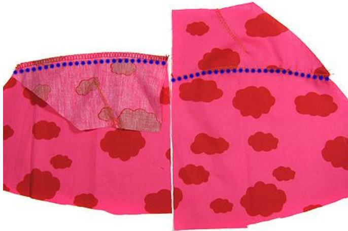
Obere rückwärtige Passe rechts auf rechts an das untere rückwärtige Rockteil stecken und nähen.
