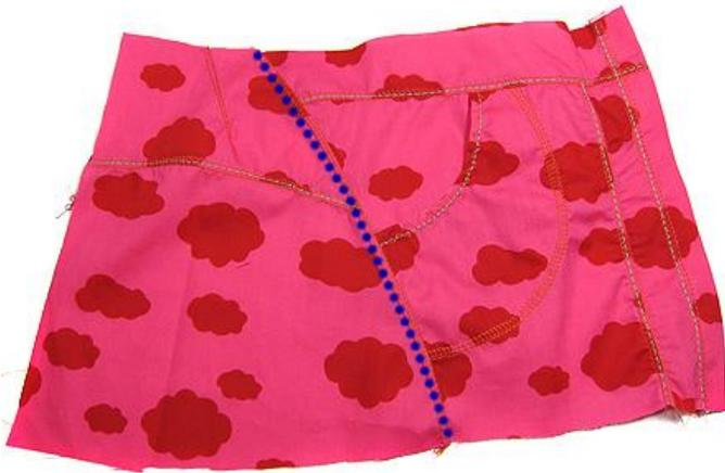
Nahtzugaben in Richtung des rückwärtigen Rockteiles klappen und die Seitennähte knappkantig absteppen.
