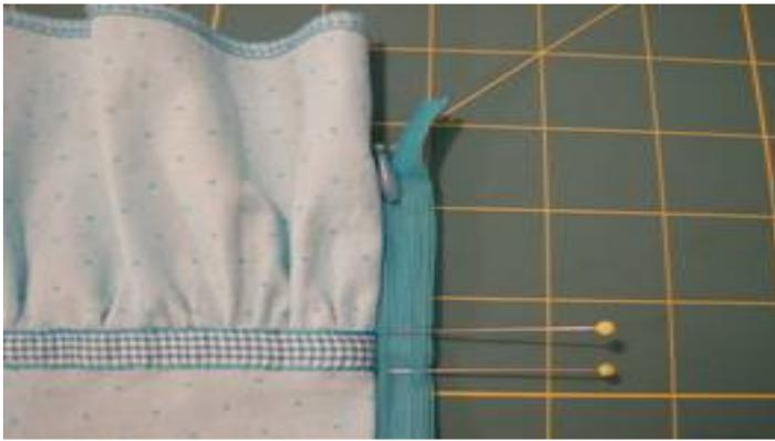
Den Reißverschluss schließen. Zwei Stecknadeln genau oben und unten vom Band als Markierung stecken.
