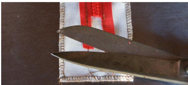
Den Reißverschluss mit einer festen Schere bzw. einer Zange kürzen.
