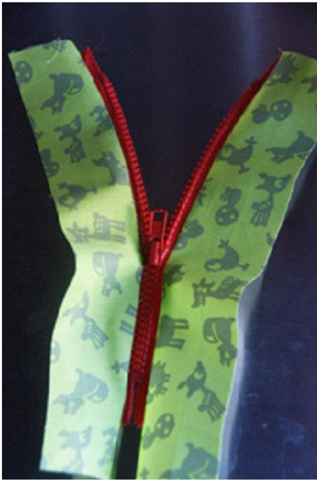
Das Reißverschlussfüßchen an die Nähmaschine anbringen und ggf. die Nadelstellung anpassen. Die Reißverschluss-Seitenteile an den Reißverschluss nähen. Die Nähte bügeln und knappkantig absteppen.
