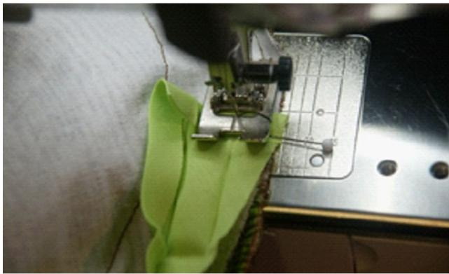
Erst das Schrägband in dem einen Falz aufnähen.
